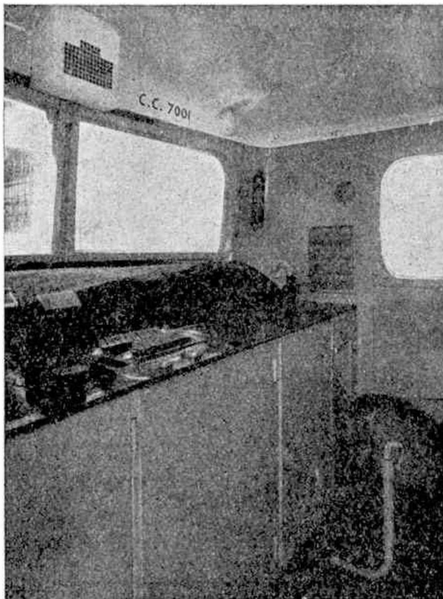
Vue intérieure de la cabine de conduite d'une CC 7000 pour trains rapides. La plaque rivée sur le tableau de bord indique : vitesse maxima en service : 175 kilomètres-heure ; en essais : 200 kilomètres-heure.
